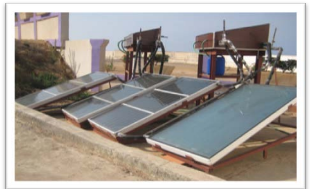
Fig. 2. Dispositif expérimental des distillateurs à effet de serre sous pression contrôlée et avec stockage d'énergie
